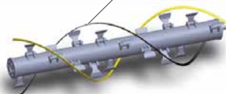
Dubbele spiraal mulch units. Deze zijn trillingsarm en vragen weinig vermogen.
