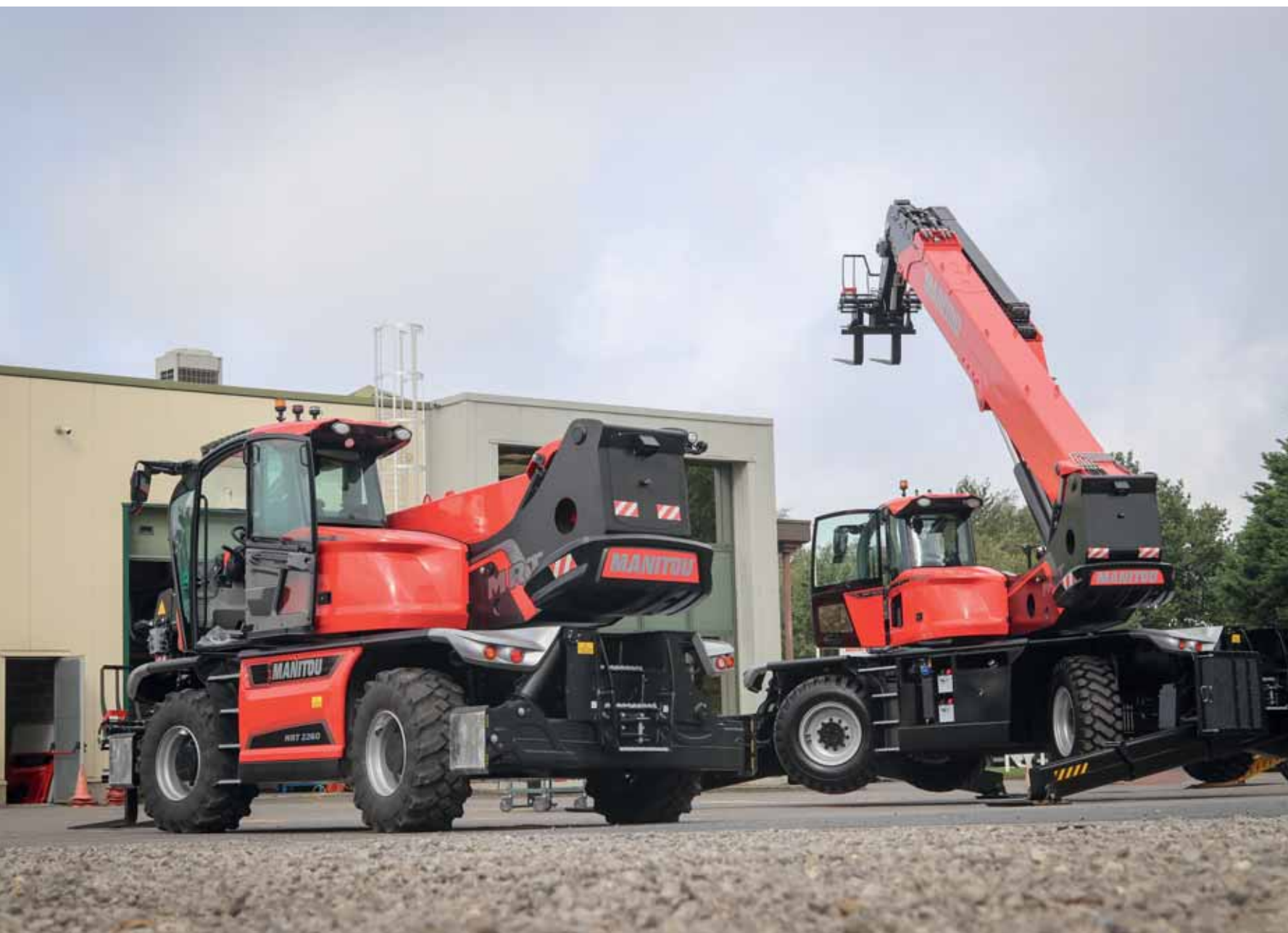
Manitou vernieuwt de hele lijn roterende verreikers inééns. Rechts de MRT3570, met een hefhoogte van 35 meter en 7 ton capaciteit het nieuwe topmodel. De concurrentie kan hoger, iets waar Manitou bewust niet in meegaat.
