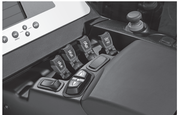
Eenvoudige bediening van alle functies zonder misgrijpen dankzij Fingertip bediening
