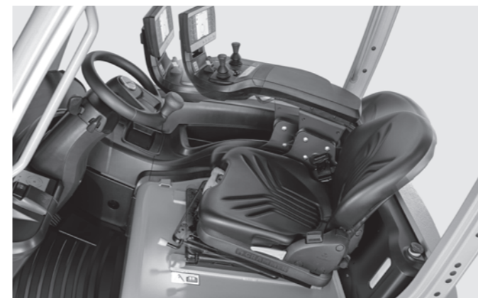
Draaistoel voor comfortabel achteruit rijden
