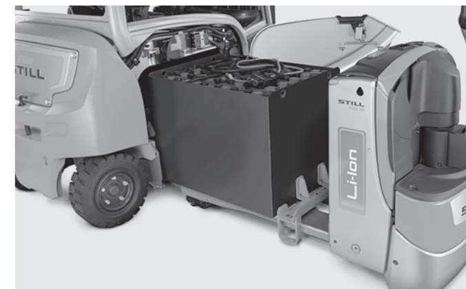
Batterij verwisselen met elektrische pallettruck
