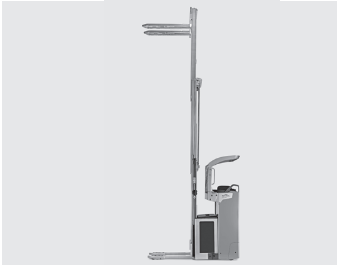
Hoge prestaties tot 1.600 kg hefvermogen en hefhoogtes tot 6.216 mm
