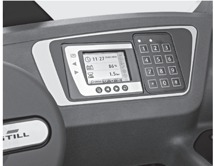
Altijd alles in beeld: display toont batterijniveau, datum en tijd
