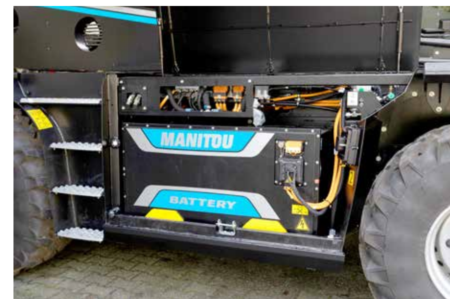
De verreikers zijn uitgevoerd met een 700 Volt 65 kW lithium-ion-batterij en een 22 kW lader.
