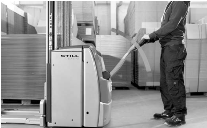
Veiligheid in het magazijn: afhankelijk van de de hoek van de dissel wordt de snelheid automatisch aangepast; afhankelijk van de afstand tussen de bestuurder en de truck
