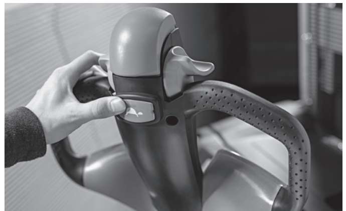
Nauwkeurig in alle situaties: kruipsnelheid maakt het ook mogelijk te manoeuvreren in kleine ruimtes
