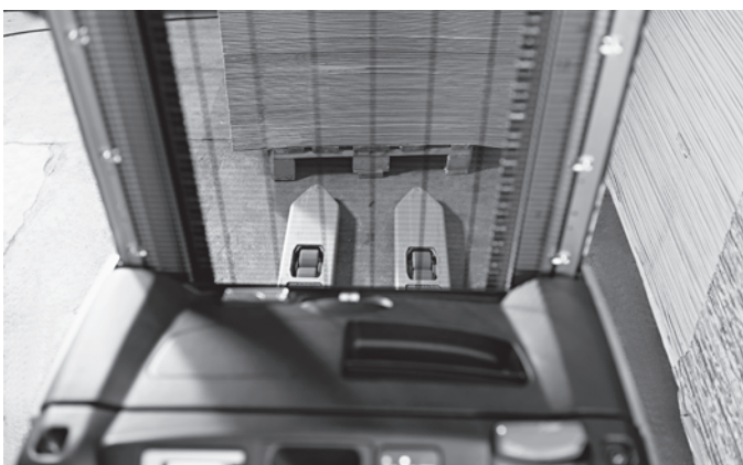
De STILL vrije doorzichtmast verzekert een uitstekend zicht op de punten van de vorken
