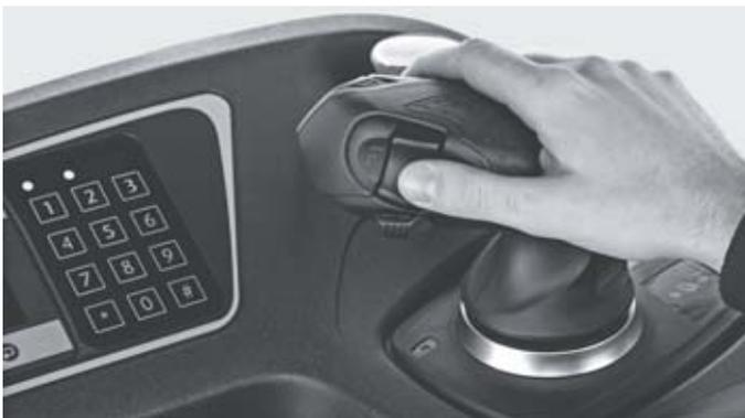
Optionaler Joystick 4Plus für Hub-, Senk- und Fahrsteuerung ohne Umgreifen
