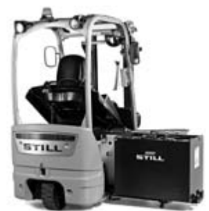
4) Onboard-batterijbrug voor het wisselen met kraan
