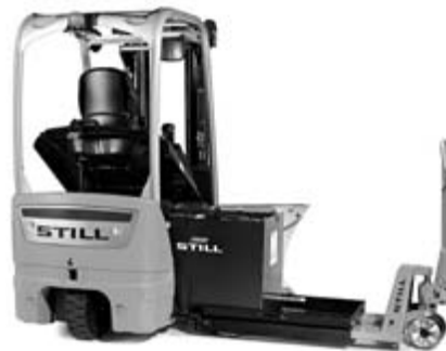
3) Wisselen met een standaard handpalletwagen, elektro pallettruck en batterijwisselrek
